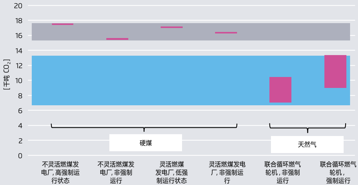
在类似的调度条件下联合循环燃气轮机发电厂和具有不同灵活性特征的硬煤发电厂在2个示例日中的二氧化碳排放量
